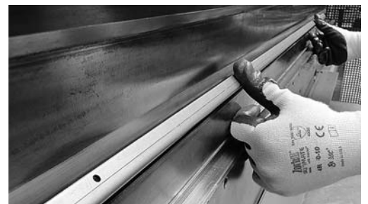
Bild 8: Korrekte Handhaltung beim zweiten Biegevorgang.
