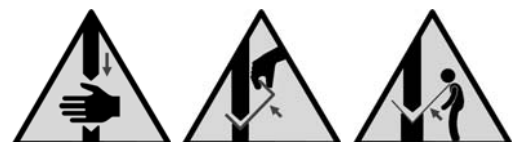
Bild 9: Restrisiken bei der Arbeit an Abkantpressen
