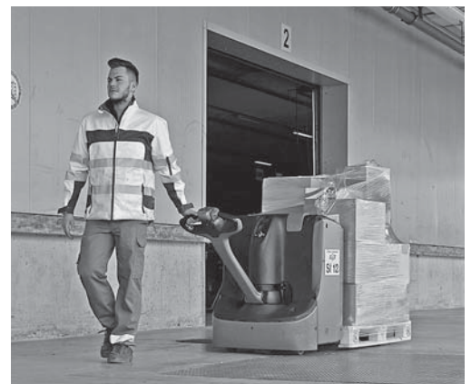
Bild 4: Deichselgeräte mit einer langen Deichsel können einfach und ohne Gefahren für die Fersen geführt werden.
