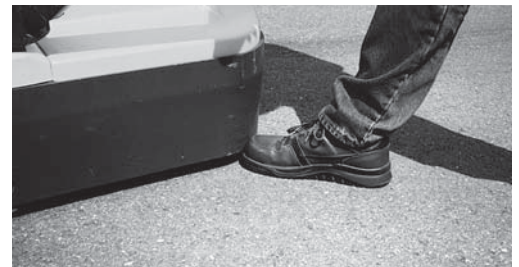
Bild 3: Ein geringer Chassisabstand zum Boden (höchstens 35 mm) bietet beim Tragen von Sicherheitsschuhen den besten Fusschutz.
