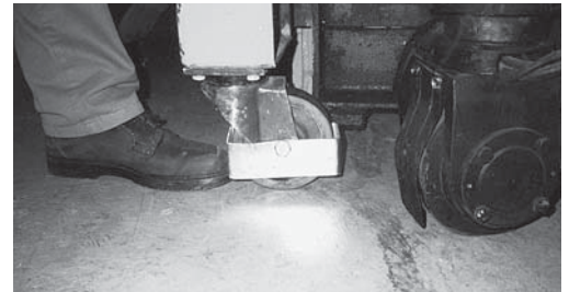
Bild 2: Radschutz und Sicherheitschuhe zusammen schützen den Bediener vor Fussverletzungen.
